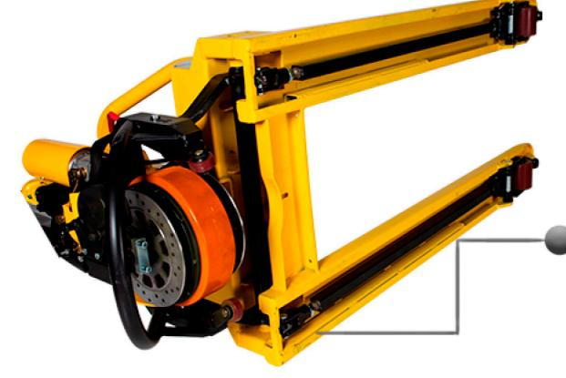
Sus llantas caster estabilizan el equipo aún en giros muy pronunciados o con cargas inestables. Construcción robusta de alta calidad Refuerzos a lo largo de las horquillas.
