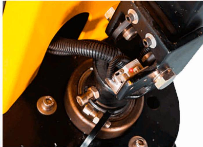
Palanca inteligente con microswitch electromagnético que activa el freno de estacionamiento.
